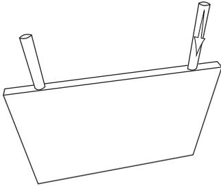
17/ Ajouter un tube à ceux du stand et ajouter le fronton par emboîtement des tubes
